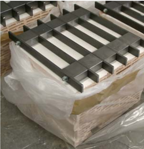
Bild 20: SX+ mit Kaolinbehandlung und Stahlschalung
