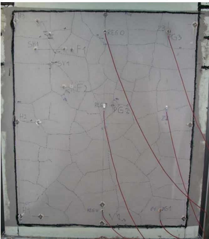
Bild 43: Putzfläche der Kombination 1 nach dem vierten Zyklus
