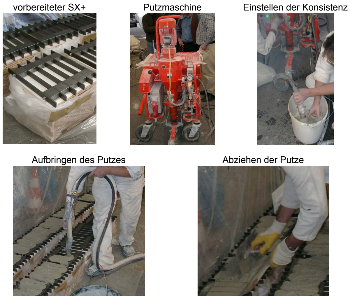
Bild 21: Herstellung der Putzprismen
