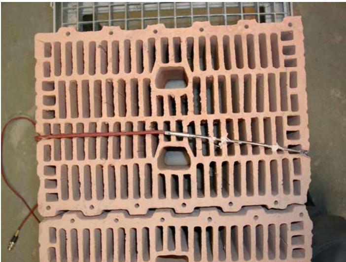
Bild 44: Messstelle zur Bestimmung der Temperatur im Bereich Putzgrund/Putz
