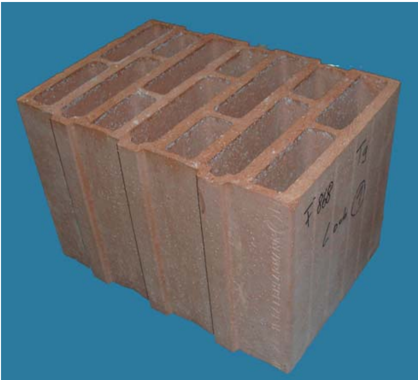
Bild B3: Planhochlochziegel T9 (ohne Perlite-Füllung)
