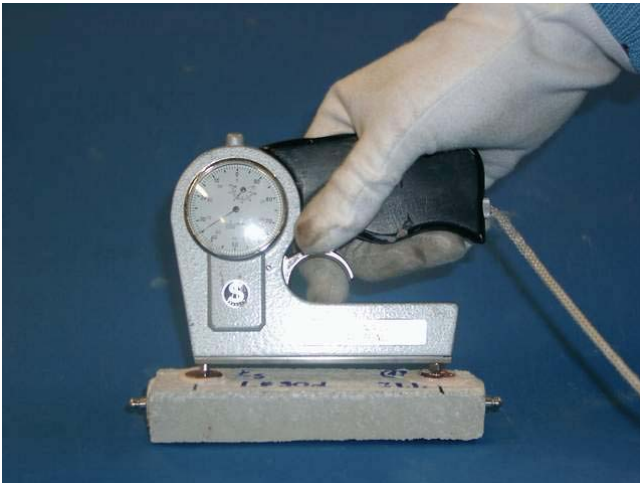
Bild 28: Messung der Längenänderung mittels Setz-Dehnungsmesser
