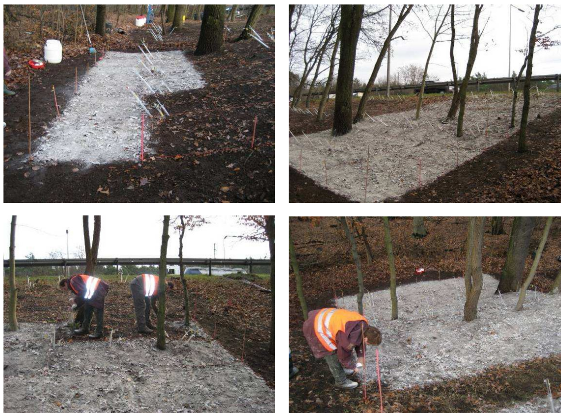
Abb. 7: Ausbringung von \text{CaCO}_3 auf der Freilandmessstelle in Form von Kalksteingrieß
