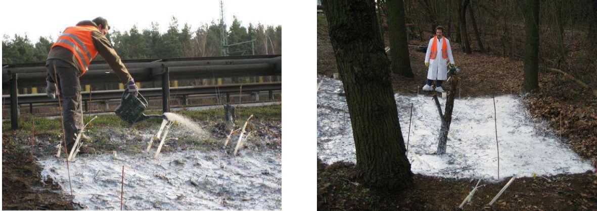
Abb. 8: Ausbringung der Kalkmilch auf der Freilandmessstelle
