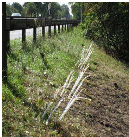
Abb. 6: Blick auf die eingebaute Saugsondenreihe in 2,5 m Entfernung vom Straßenrand (Linke Seite) und vereinfachte Draufsicht auf die Messstelle. Linker Block = Referenzfläche/ \text{Ca}(\text{OH})_2 ; Rechter Block = \text{CaCO}_3 mit den jeweiligen Sondenbezeichnungen (Rechte Seite)
