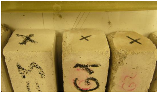
Abb. 5.4.19: Abplatzungen an Probe G nach 5 Zyklen
