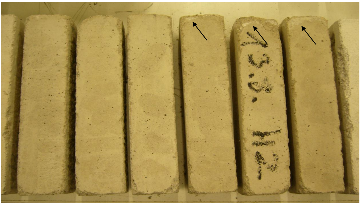
Abb. 5.4.18: Dokumentation der Proben G (linke 3 Prismen) und H (rechte 3 Prismen) nach 5 Zyklen, Ausblühungen und Abplatzungen auf den Proben H (siehe Pfeile)
