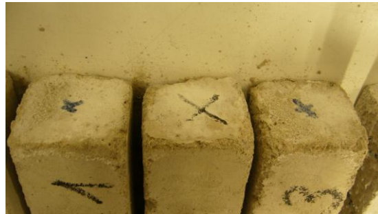
Abb. 5.4.20: Abplatzungen an Probe H nach 5 Zyklen
