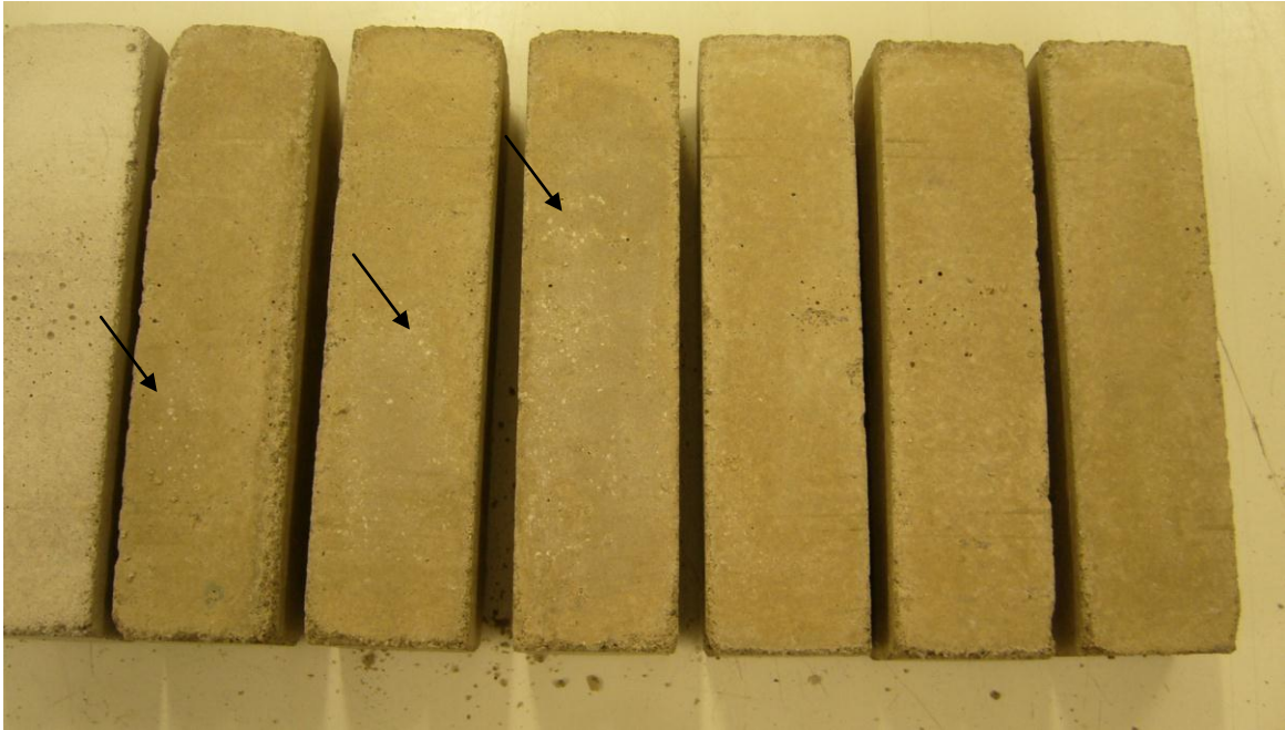
Abb. 5.4.17: Dokumentation der Proben C (linke 3 Prismen) und D (rechte 3 Prismen) nach 5 Zyklen, Ansätze von Ausblühungen auf den Proben C (siehe Pfeile)
