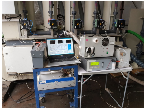
Abb. 29: Messgeräte-Aufbau am Versuchswäscher
