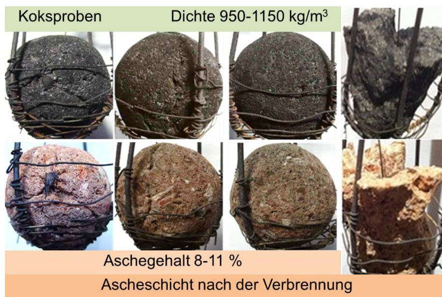
Abbildung 2-15: Koksproben vor und nach der Verbrennung [40].
