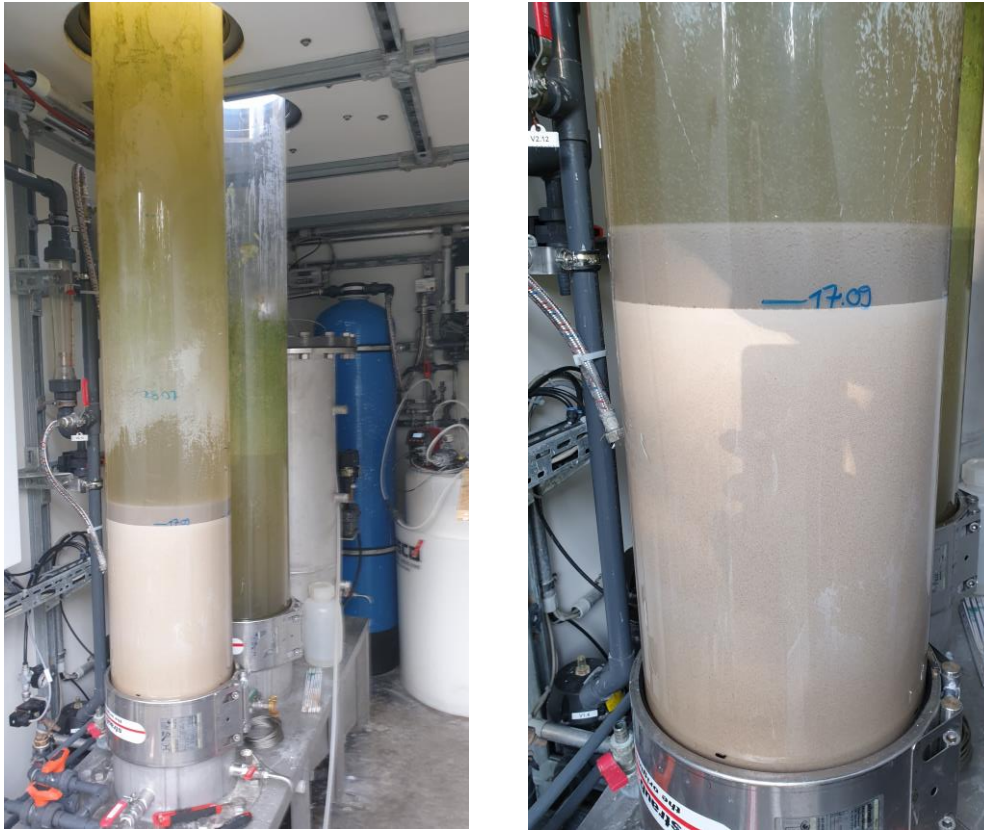
Abbildung 27: Der Pelletreaktor mit den Dolomitimpfkörnern bei der Messkampagne mit Rücklösewasser. In der Detailaufnahme rechts ist die bräunliche Färbung des Wassers im oberen Drittel zu sehen. Außerdem sind in der Wassersäule weiße Flocken zu erkennen, die einen gewissen Anteil an Calciumcarbonat und/oder Calciumphosphat enthalten. Direkt unterhalb der Wassersäule befindet sich der bräunliche Fällschlamm der sich nach dem Reaktorstopp akkumuliert hat. Die Pelletentnahme erfolgte aus dem untersten Teil der Säule.
