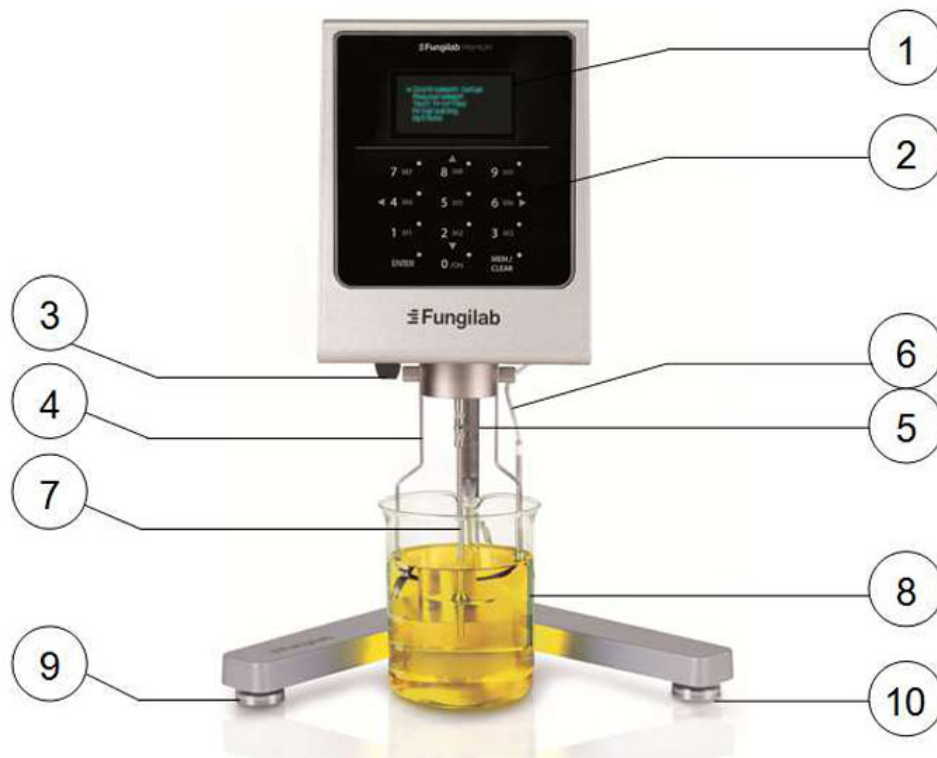
1: Display; 2. Tastatur; 3: Nut; 4: Spindelschutz; 5: Befestigungsschraube; 6: Temperatursensor; 7: Spindel; 8: Becherglas; 9/10: höhenverstellbare Füße
