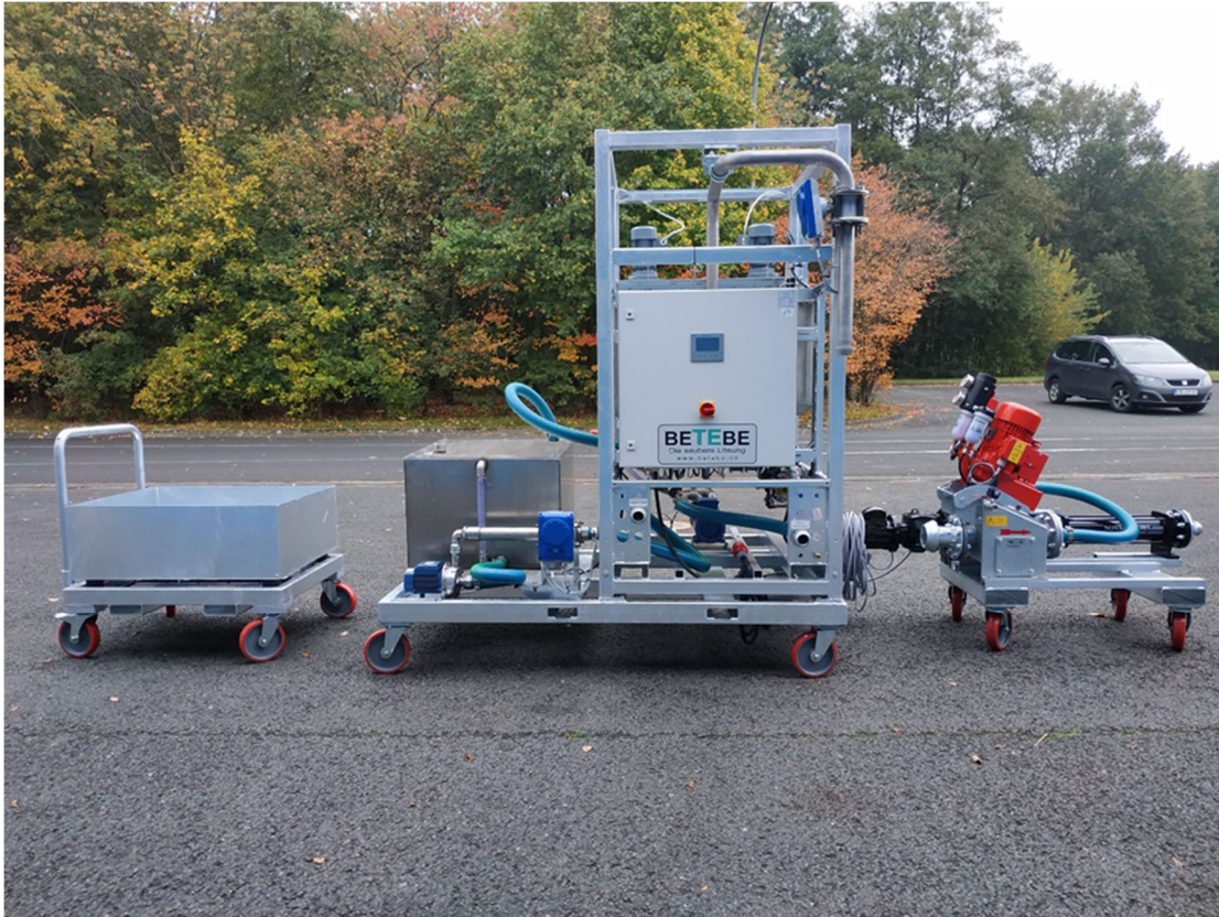
Abbildung 3-2: Feinseparator "VakuSep" der Fa. BETEBE (Links: Wiegeeinheit; Mitte: Separator; Rechts: Mazerator-Pumpen-Kombination)
