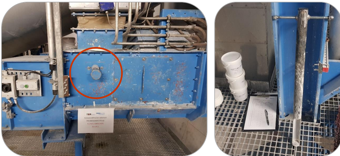
Abbildung 6.11: Probenahmestelle SS 3.4.1 unterhalb Filter 2 zur Entnahme von im Filter 2 abgeschiedenem Feststoff (links), genutzter Probenehmer (rechts).
