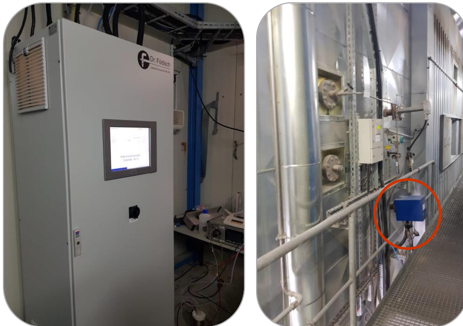
Abbildung 6.7: Analysator Födisch MCA10-HWIR (links), Position der Entnahmesonde (rechts) zur Messung der Zusammensetzung des Rohgases an Position Gas 1.1.1.
