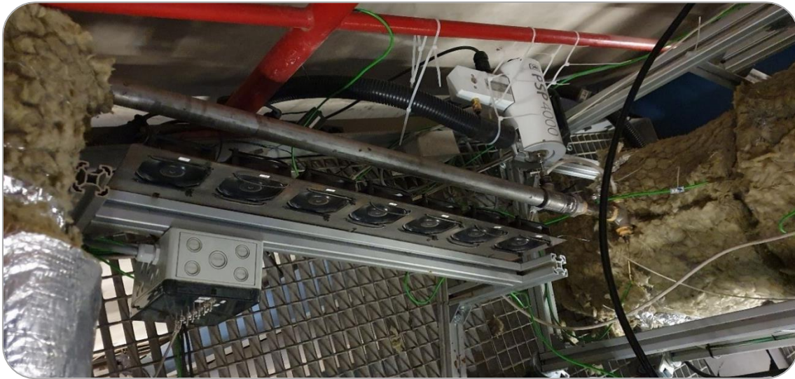
Abbildung 5.6: Dem Reaktor nachgeschaltete Gaskühlung und Entnahmesonde für die Gasmessung.
