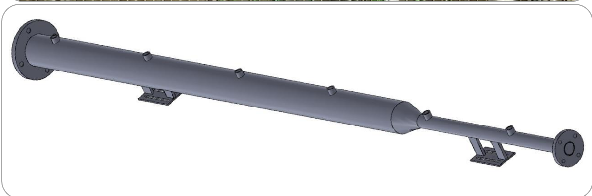
Abbildung 5.5: Flugstromreaktor gedämmt und installiert an der MKVA Krefeld (oben), als CAD-Zeichnung (unten).
