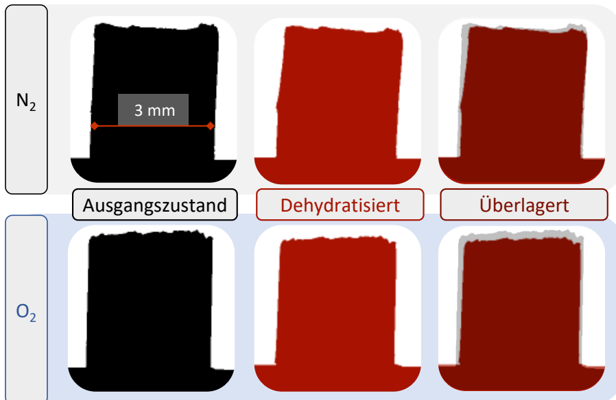
Abbildung 3.14: Untersuchung der Dehydratisierung von Kalkhydrat im Erhitzungsmikroskop unter N 2 - und O 2 -Atmosphäre.
