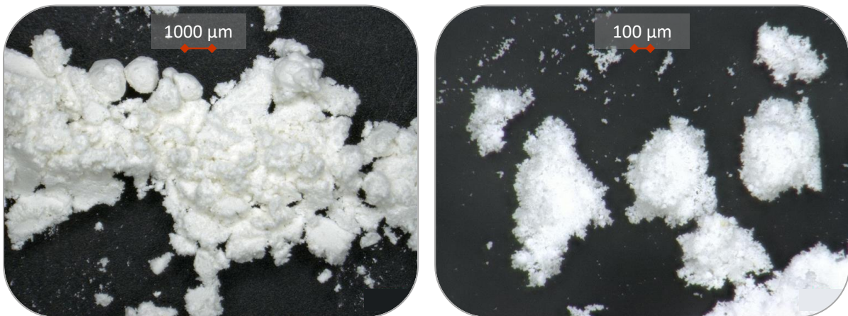
Abbildung 3.2: Probe des Kalkhydrats KH3 (Lichtmikroskopie, Vergrößerung links x30, rechts x200).
